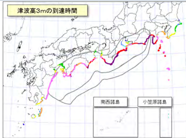
【ケース①「駿河湾～紀伊半島沖」に「大すべり域+超大すべり」域を設定】
